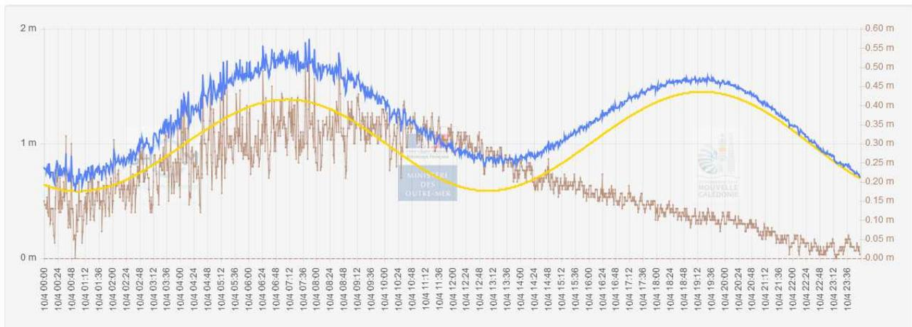
Figure 8: Donnée du marégraphe de Ouinné du 10 Avril 2017. La marée prévue est représentée par la courbe jaune. Le niveau réel observé de la mer est représenté par la courbe bleue. La surcote, différence entre le niveau observé et le niveau prévu, est représentée par la courbe marron et se mesure sur l'axe des ordonnées à droite. Source : <http://data.shom.fr>
